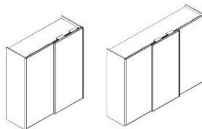
**SPACE AIR 36** – это система, предназначенная для изготовления отдельно стоящих шкафов-купе с раздвижными фасадами. Отличительной особенностью является наличие доводчиков, интегрируемых в направляющие, которые позволяют сделать открывание и закрывание фасада мягким и бесшумным.
