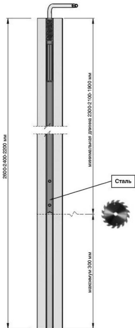
**!** Возможна обрезка профиля по длине максимум на 300 мм от нижнего края выравнивателя. Верхний край имеет метку.
