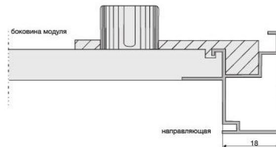
Схема регулировки усилия.
