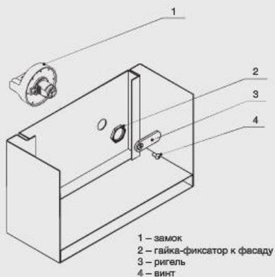
Отверстие под установку на металлический фасад
