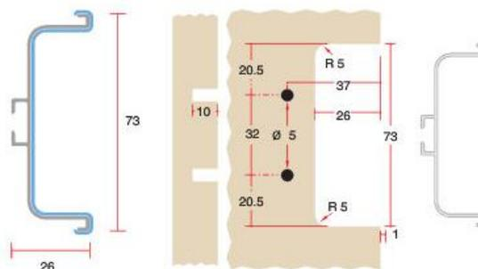
профиль горизонтальный с двумя закруглениями
