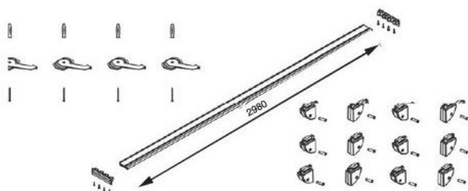
карниз 4-х рядный L.3000мм, для потолочного крепления декоративных панелей, в комплекте с крепежом
