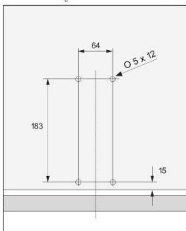
Присадочные размеры для фиксаторов нижней направляющей
