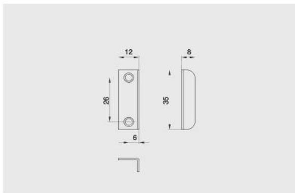
Установка на металлический фасад
