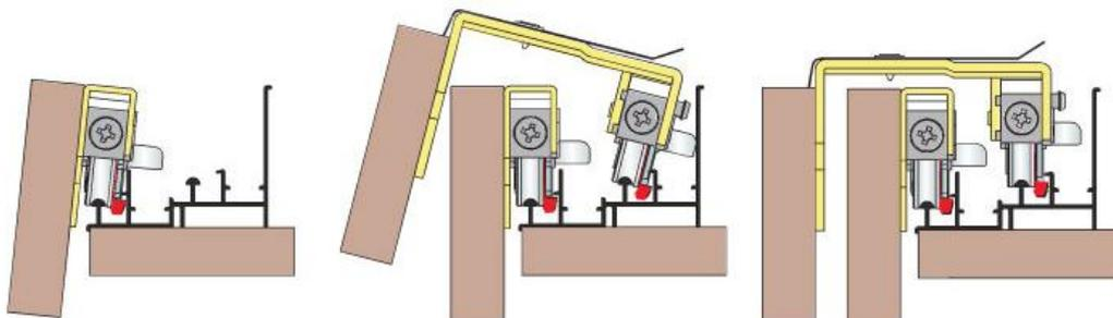
СХЕМА УСТАНОВКИ ФАСАДОВ НА НИЖНЮЮ НАПРАВЛЯЮЩУЮ.
