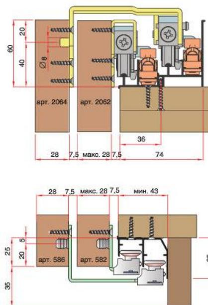
ВАРИАНТ ДВУХДВЕРНОГО ШКАФА – ВИД СВЕРХУ. СХЕМА РАСПОЛОЖЕНИЯ ДОВОДЧИКОВ.
