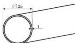
штанга для шкафа, диаметр 25 мм
