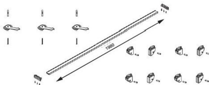
карниз 3-х рядный L.2000мм, для потолочного крепления декоративных панелей, в комплекте с крепежом
