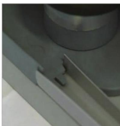
8. Установить базу в пазы боковин барабанного механизма и выровнять по переднему краю боковины корпуса.
