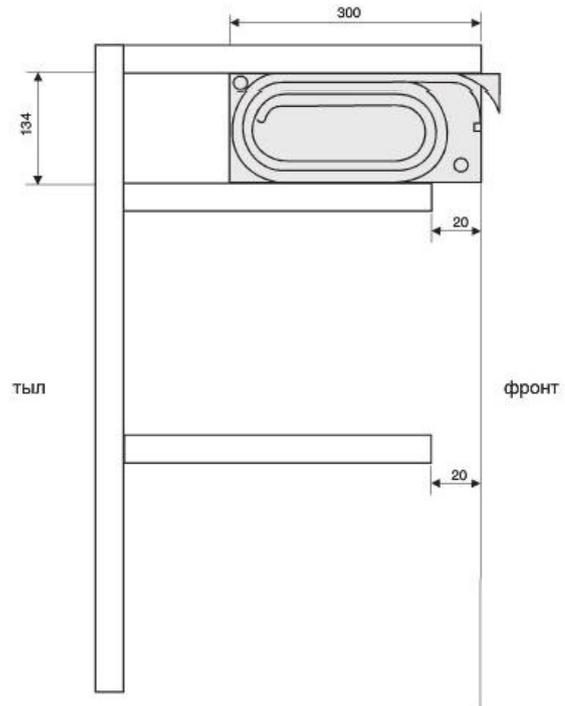
Схема стыковки модуля VOXMILANO и направляющих (вид сверху).
