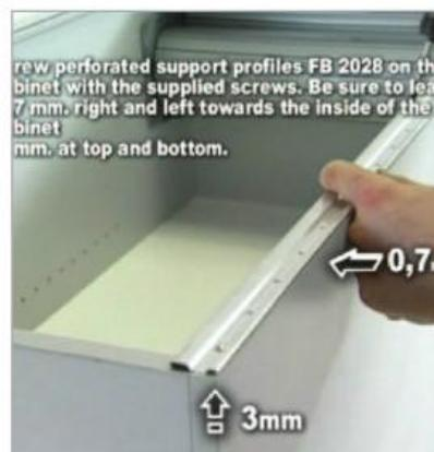
21.22.23. Взять профиль-держатель боковой накладки арт. FB 2028, установить на торце боковины корпуса и зафиксировать саморезами, соблюдая отступы: 3 мм от внешнего края верхней и нижней панели и 0,7 мм от внешнего края боковины корпуса.
