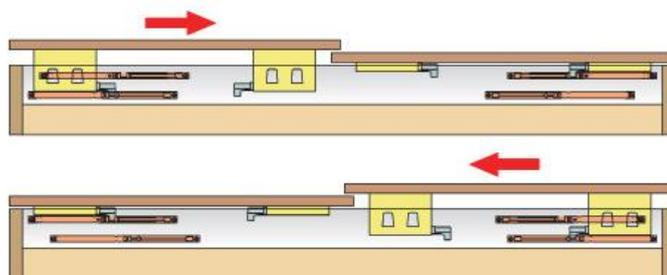
ВАРИАНТ ТРЕХДВЕРНОГО ШКАФА – ВИД СВЕРХУ. СХЕМА РАСПОЛОЖЕНИЯ ДОВОДЧИКОВ.
