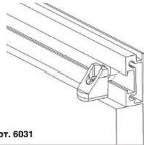
Монтаж профиля арт. 103А с помощью крепления арт. 6031
