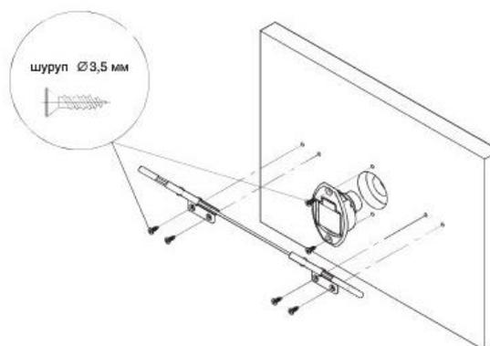
4. Установите фасад на каркас шкафа
