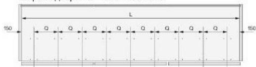
Вариант трехдверного шкафа с секционными верхними и нижними панелями каркаса.
