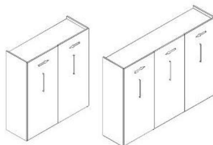
Система **PLANO** очень проста в использовании: в закрытом состоянии все двери шкафа находятся в одной плоскости, а при открывании, дверь, выдвигаясь, плавно скользит параллельно закрытой двери.
