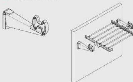
Возможна установка на полку с помощью опоры для крепления выдвижных элементов к полкам арт. SSNBP163x (см. стр.32.27)
