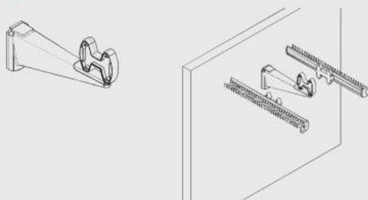
Возможна установка на полку с помощью опоры для крепления выдвижных элементов к полкам арт. SSNBP163x (см. стр.32.27)
