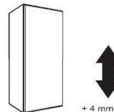
Схема фронтальной регулировки
