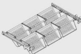
**!** Высота с установленными лотками для обуви 176 мм, глубина 500 мм
