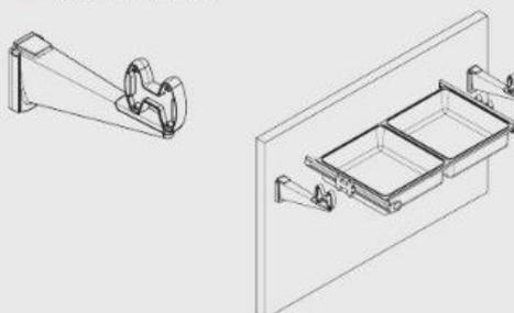
Возможна установка на полку с помощью опоры для крепления выдвигаемых элементов к полкам арт. SSNBP163x (см. стр. 32.27)
