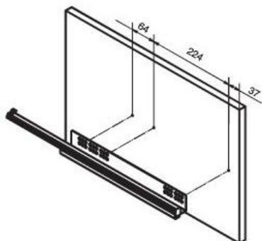
направляющая Quadro V6 полного выдвижения с доводчиком Silent System, 500 мм, левая
