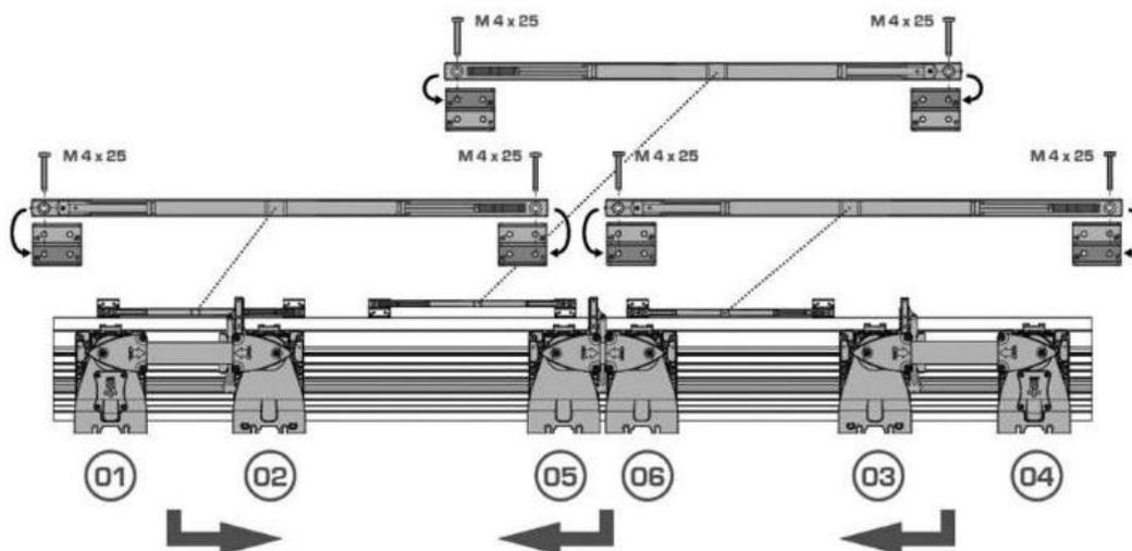
схема установки для трёхдверного шкафа,
