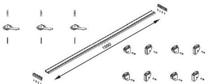
карниз 4-х рядный L.2000мм, для потолочного крепления декоративных панелей, в комплекте с крепежом
