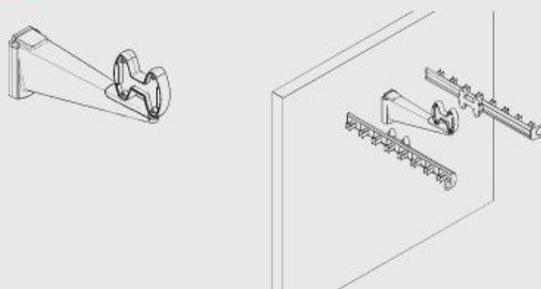
Возможна установка на полку с помощью опоры для крепления выдвижных элементов к полкам арт. SSNBP163x (см.стр.32.27)
