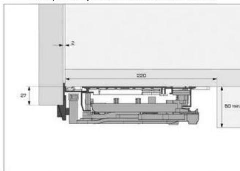
Расчет высоты фасада в зависимости от высоты каркаса шкафа
