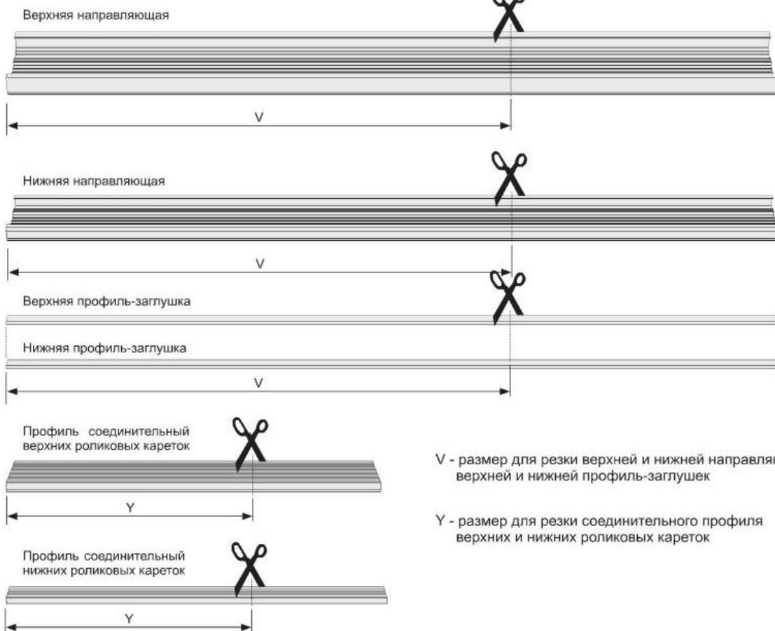
V - размер для резки верхней и нижней направляющих, верхней и нижней профиль-заглушек
