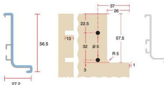
профиль горизонтальный с одним закруглением
