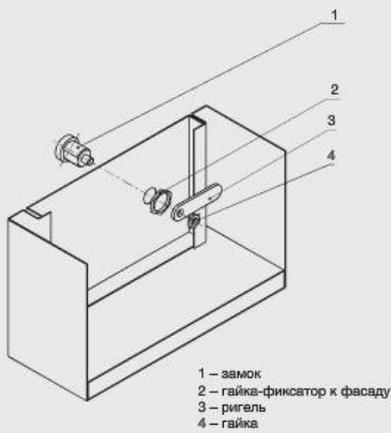
Отверстие под установку на металлический фасад
