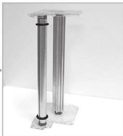
4. Берем барабанный механизм, снимаем одну из боковин, вынимаем вал намотки.
