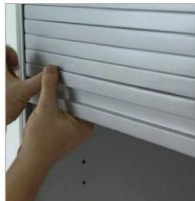
18.19.20. Взять профиль под установку ручки арт. FB 2009 или профиль-ручку арт. FB2011, с предустановленными бегунками-заглушками, установить в направляющие и соединить с полотном шторок-жалюзи путем защелкивания.
